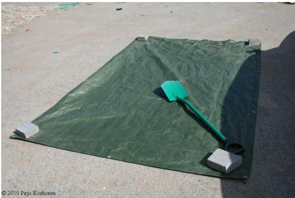
Kuva 2. Näytteenotto väline ja alueen suojaus.
