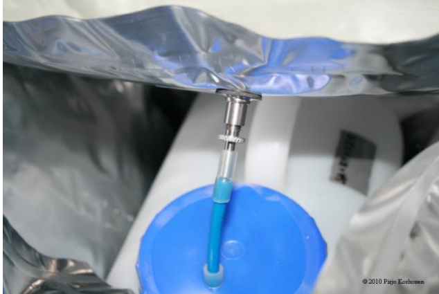
Kuva 18. Kaasunkeräysnäytepussin kiinnitys kaatopaikkakaasun koeastiaan.
