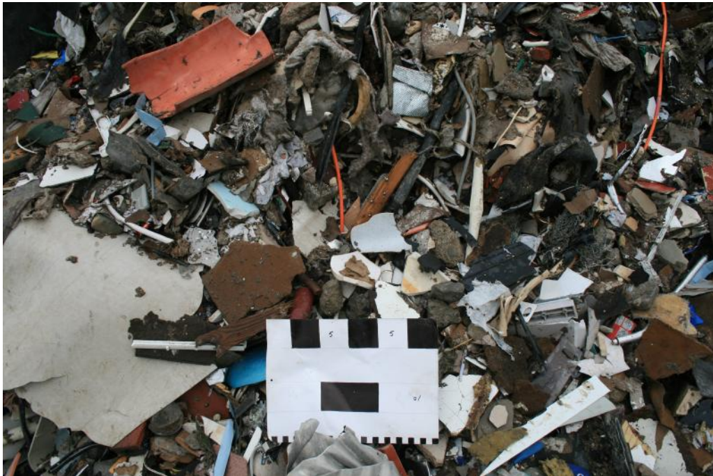
Kuva 6. Teollisuuden prosessijätteen sekä rakennus- ja purkujätteen käsittelyssä syntyvää kellutusalitetta.
