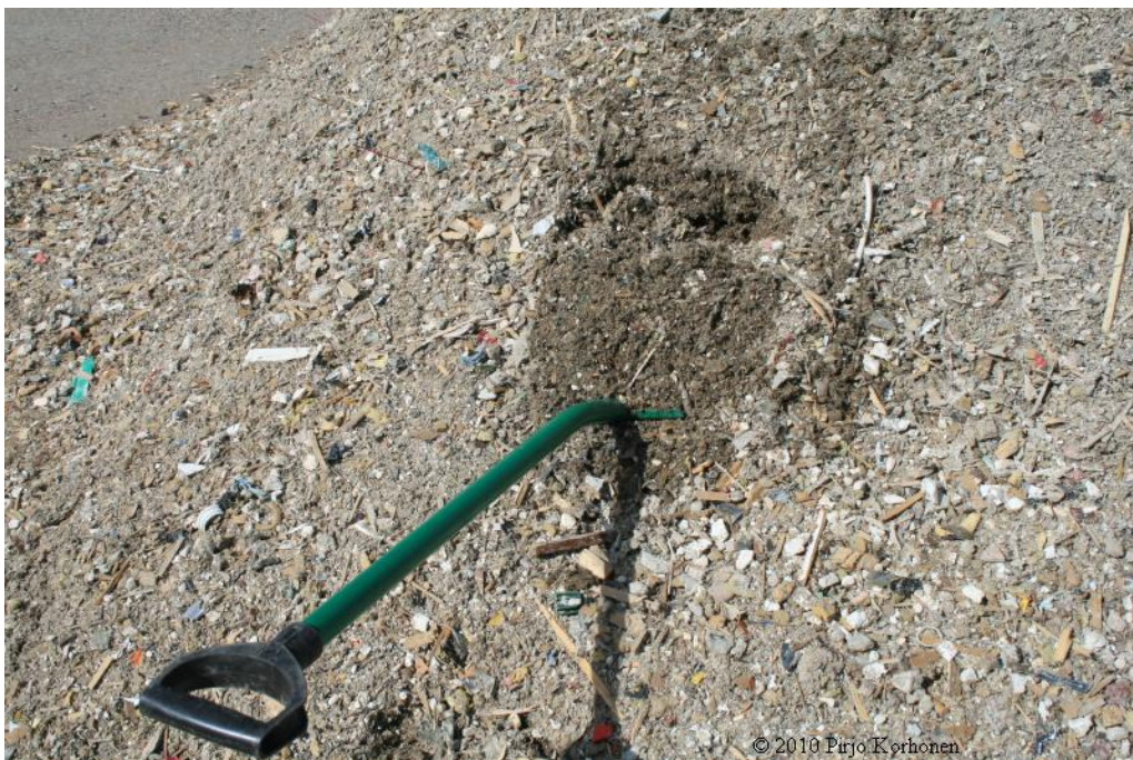
Kuva 4. Osanäytteen otto kasasta näytteenotto korkeudelta.
