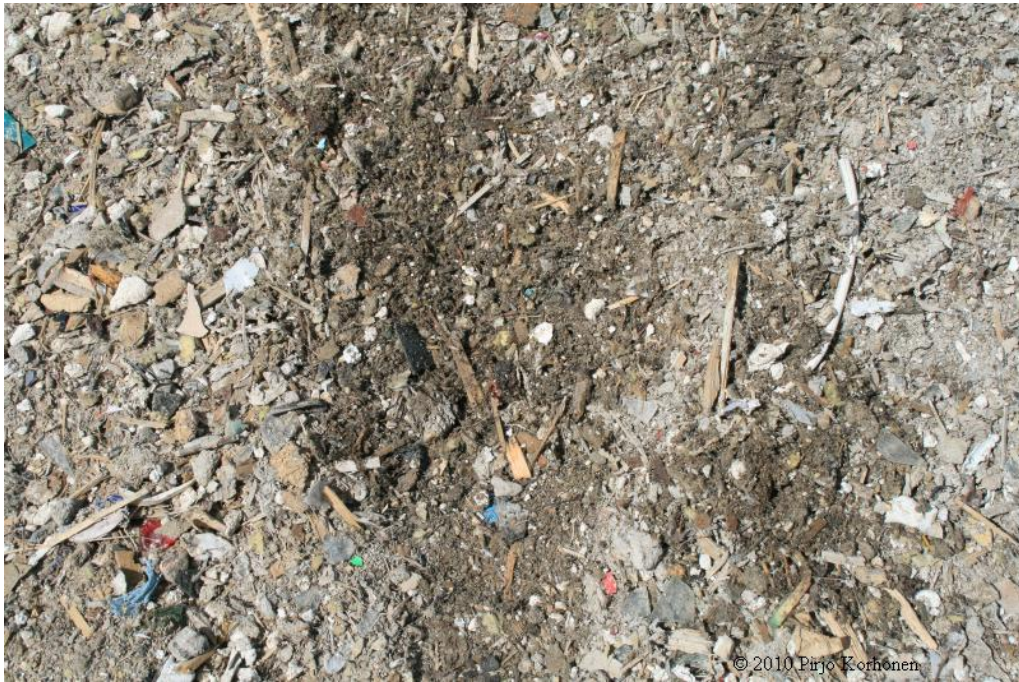
Kuva 3. Poistetaan pinnasta kuivunutta materiaalia ennen osanäytteen ottoa.
