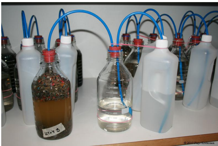
Kuva 17. Kaasuntuottoa 12. päivänä reaktorin valmistamisesta.
