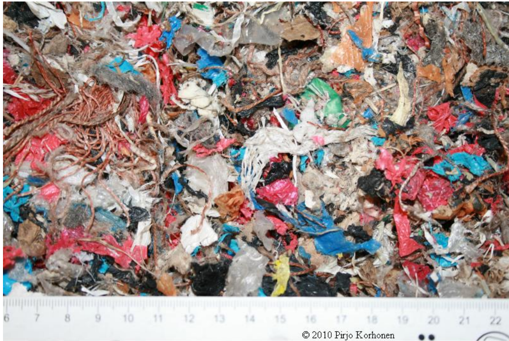
Kuva 8. Hylyn näyte ensimmäisen murskauksen jälkeen.
