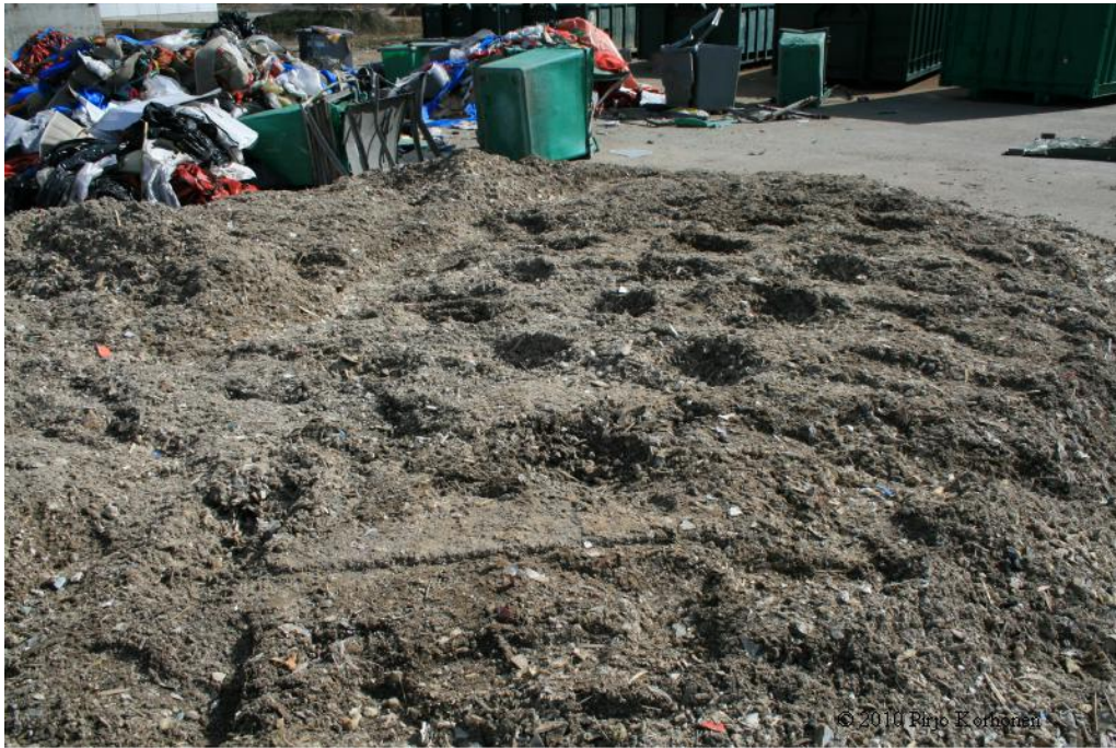
Kuva 7. Osanäytteiden otto kasan sisältä kolmioverkkomallilla.
