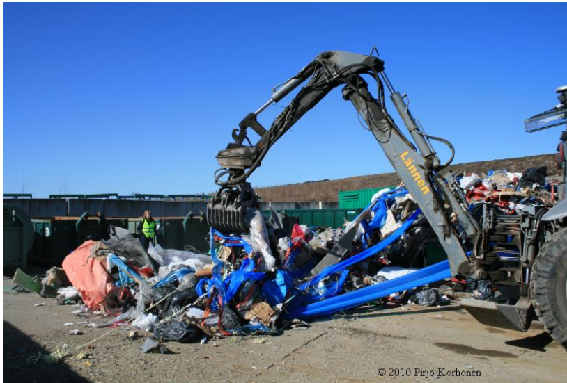
Kuva 9. Hylkyerän sekoittaminen aumaksi.
