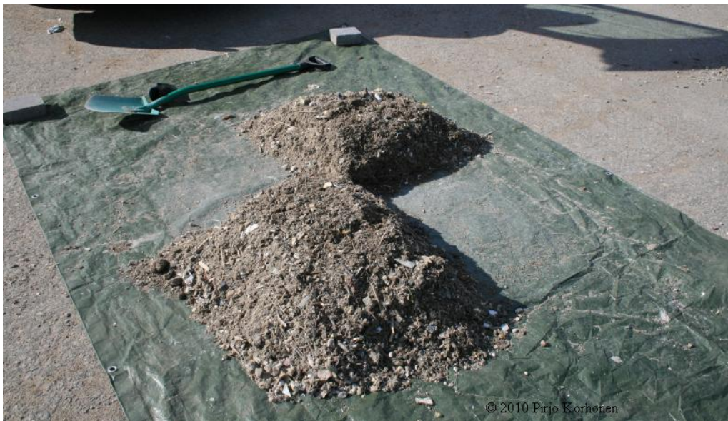
Kuva 10. Näytteen puolitus poistamalla diagonaaliset neljännekset.
