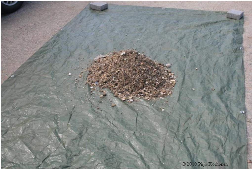
Kuva 5. Osanäytteiden kasaus näytekeoksi.
