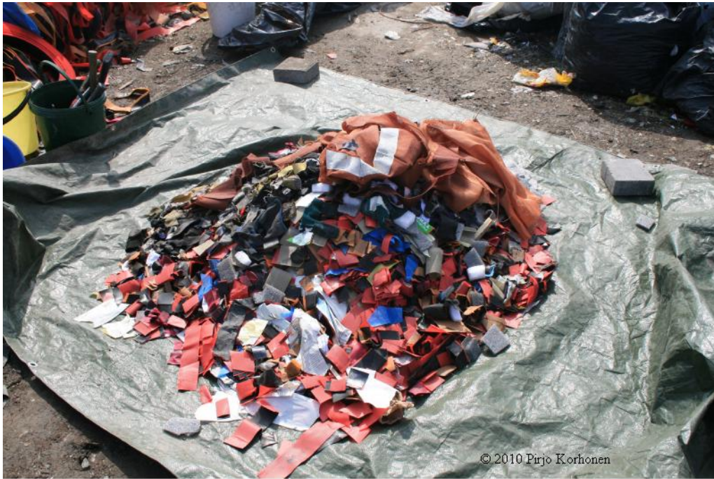
Kuva 6. Harkinnanvaraisen kokoomanäytteen kasaaminen.
