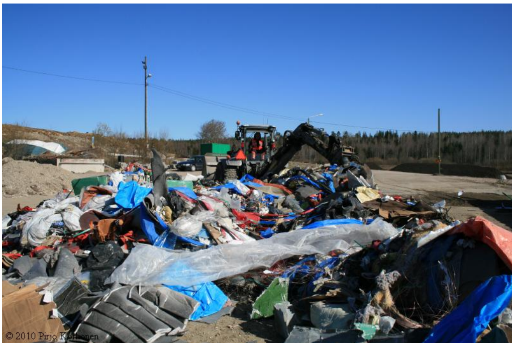
Kuva 2. Hylkyerän sekoittaminen aumaksi.
