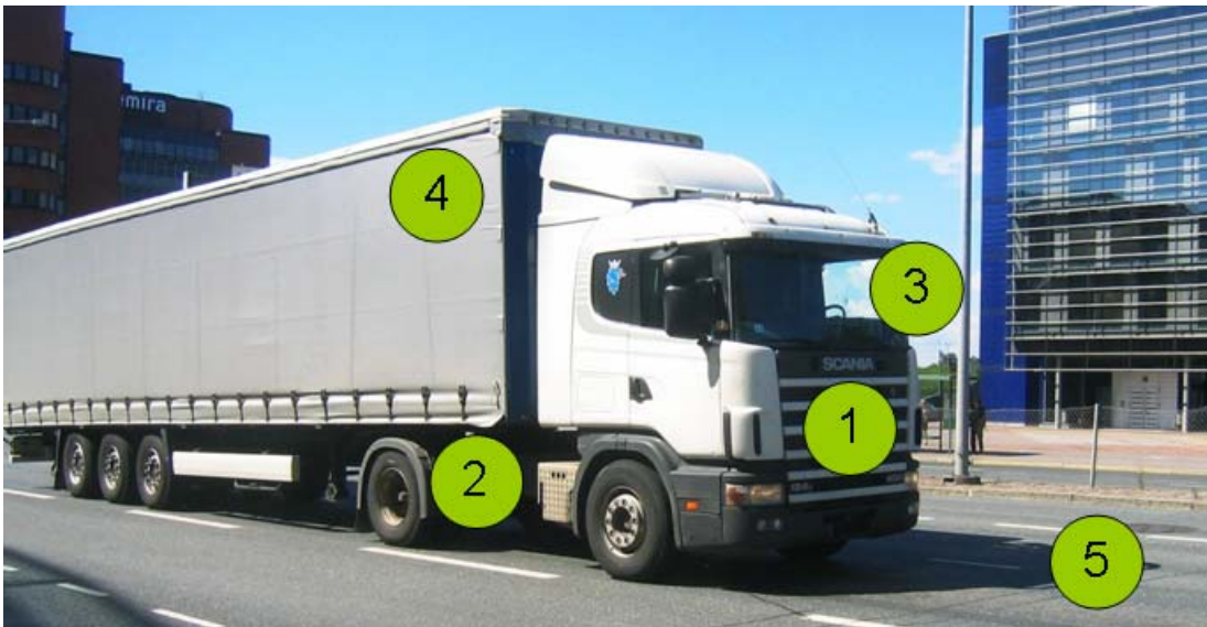
Kuva 3. Polttoaineen kulutuksen vaikuttavat tekijät ovat (1) ajoneuvotekniikka, (2) polttoaineen ominaisuudet, (3) kuljettajan ajotapa, (4) kuorma ja (5) ulkoiset tekijät. (Kuva: WSP Finland 2007.)
